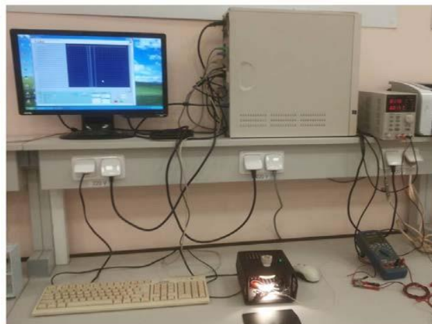
16 pav. Saulės elemento voltamperinės charakteristikos matavimo įranga.
