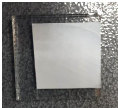
9 pav. Išdžiovintas TiO 2 sluoksnis.
