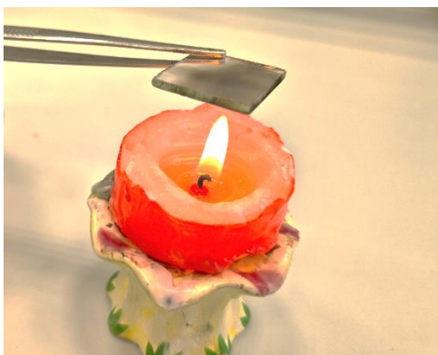
11 pav. Stiklo plokštelės laidaus sluoksnio padengimas suodžiais
