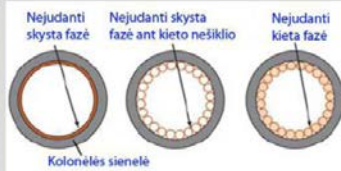
Kapiliarinės chromatografinės kolonėlės pjūvis
